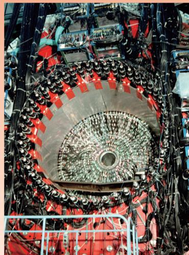
1988 年 10 月，我国第一座高能加速器——北京正负电子对撞机首次对撞成功。图为北京正负电子对撞机的大型探测系统——谱仪。
