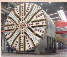
隧道掘进设备设计、制造、施工技术达到国际领先水平。“天和号”是我国研制的世界上最大、直径达 15.03 米的泥水气压平衡复合式隧道掘进机。
